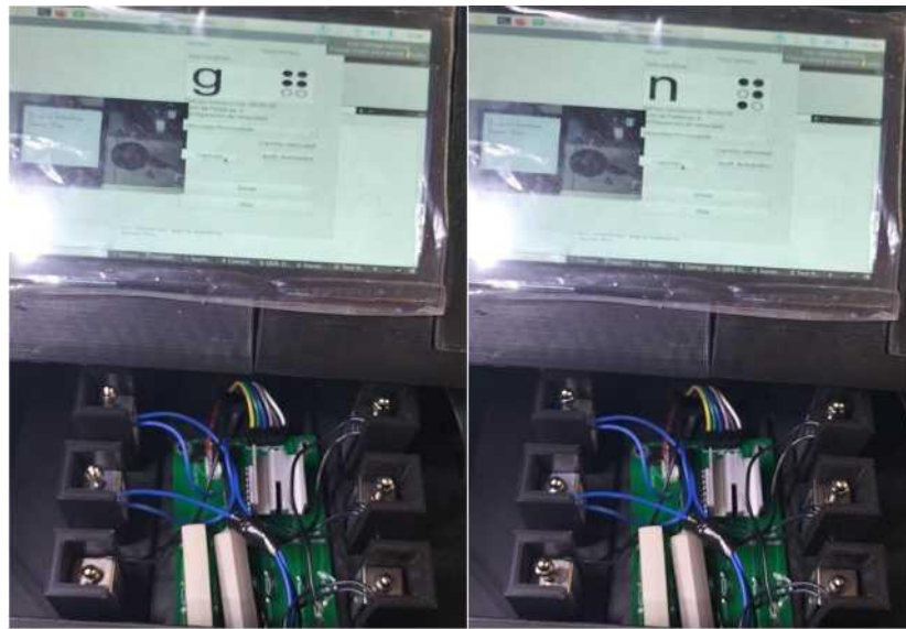
Fig. 16. Implementación de los actuadores para representar las letras g y n.
