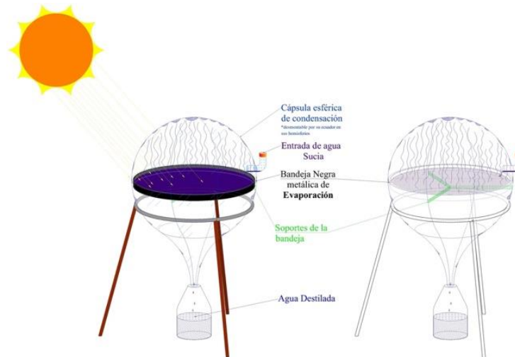
Fig. 6. Destilador solar esférico.
