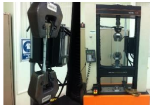
Fig. 2. Máquina para pruebas de Tensión a temperatura ambiente
