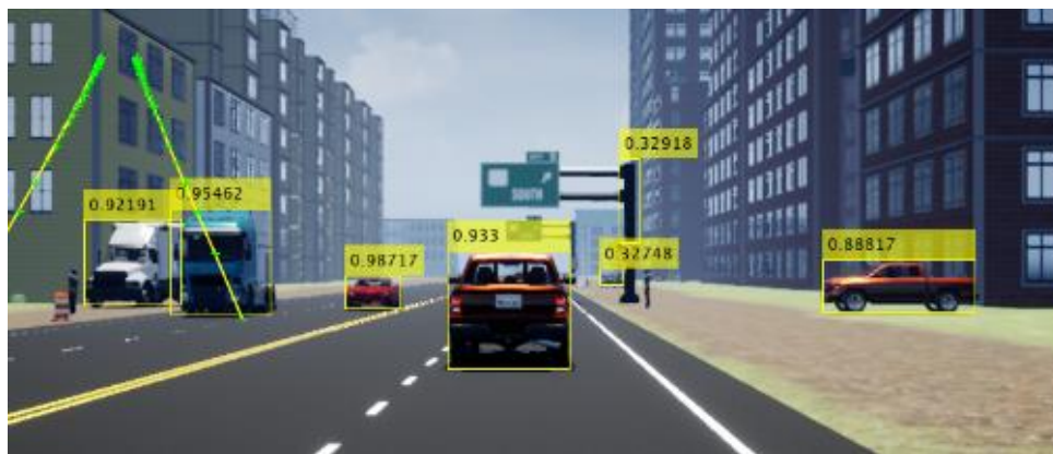
Fig. 13. Detección de objetos a través de la cámara con YOLOv2.
