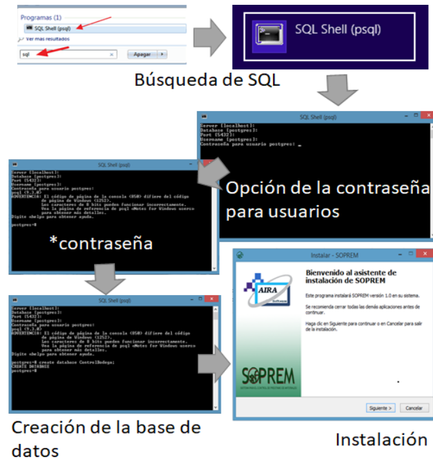
Fig. 5. Proceso para la instalación de SOPREM.
