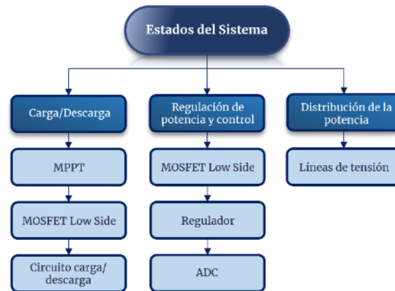
Fig. 3. Estados y dispositivos principales de cada estado de operación.
