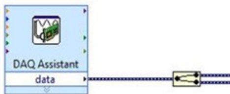
Fig. 5. Bloque de adquisición de la señal dual y la separación en dos componentes (canción y ruido).
