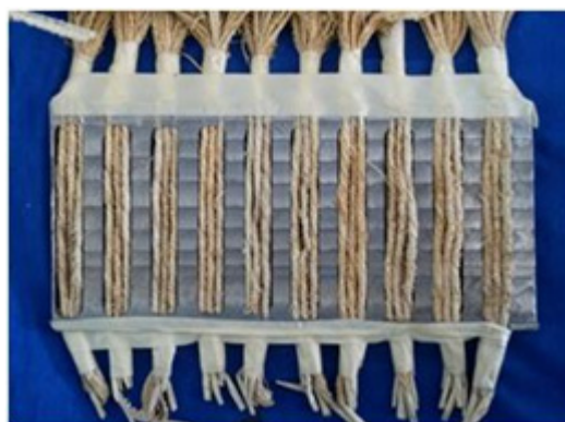
Fig. 5. Molde con fibras de banana colocadas.
