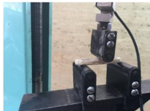
Fig. 7. Máquina MTS con la probeta colocada entre apoyos para ensayo de flexión.
