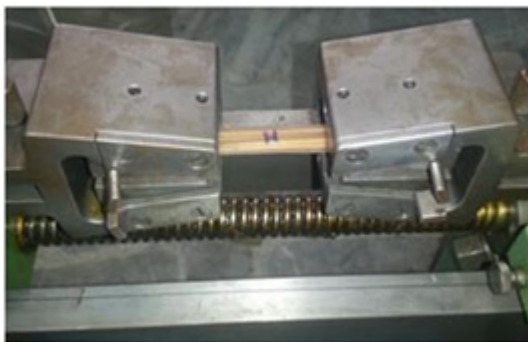
Fig. 6. Mordaza de la máquina AMSLER para ensayos de tracción horizontales.
