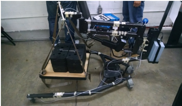
Fig. 13. Imagen de la grúa cargando 36 kg.
