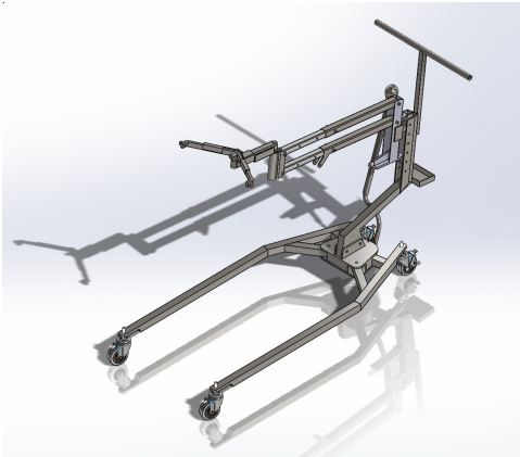
Fig. 17. Ensamble final de la grúa en SolidWorks® 2014.
