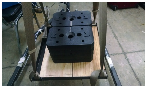
Fig. 12. Pesas utilizadas para la realización de las pruebas en la grúa.
