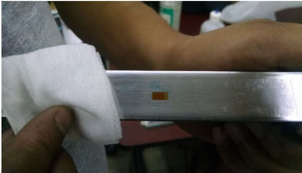
Fig. 5. Galga pegada y alineada con los ejes de referencia trazados.
