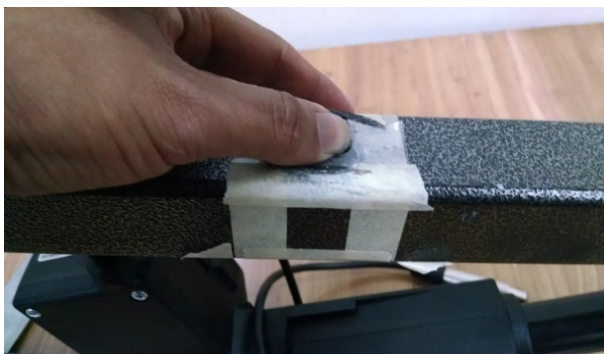
Fig. 6. Imagen que muestra el procedimiento de hacer presión directamente con el dedo pulgar sobre la cinta celofán que cubre la galga recién pegada, a fin de ayudar en la adhesión de la misma con la superficie.
